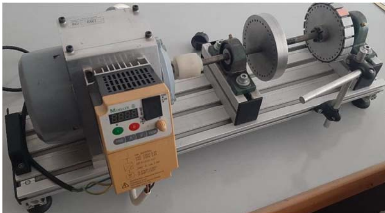
Пробни сто за динамичка испитивања и анализу вибрација
