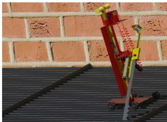
Машина за чишћење цијевног система котла термоелектране
