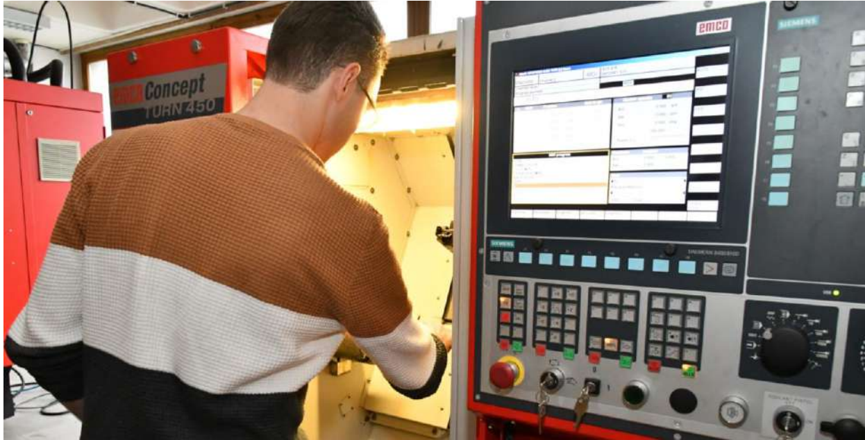
Нумерички управљани струг EMCO Concept Turn 450
