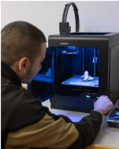
3D штампач Zortrax M200 за штампање FDM поступком
